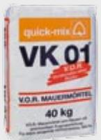
**VK 01** — этот раствор годится для укладки сильно абсорбирующего облицовочного камня с водопоглощением 8–10%, компенсирует его водопоглощающее свойство и гарантирует оптимальную прочность сцепления с основанием и непроницаемость. При использовании рядового раствора, камень сразу же абсорбирует воду из раствора, и раствор «сгорает». Вследствие этого раствор хуже схватывает, что влечет за собой незначительную прочность сцепления с основанием и проникновение воды в каменную кладку.
